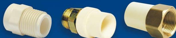
Hay disponible una variedad de transiciones especiales que integran empaques elastoméricos en la unión Metal-CPVC FlowGuard Gold® EcoTec y deben ser utilizados en líneas donde la temperatura del agua alcance 66°C. Para una transición de CPVC a metal, se recomienda el uso de adaptador macho de CPVC FlowGuard Gold® EcoTec y el hembra de CPVC con inserto de bronce.
