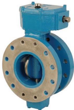
Henry Pratt ahora ofrece con presión de trabajo de 350 psi, ANSI 250, la primera válvula de mariposa de este tipo en la industria. Esta válvula es excelente en los usos de alta presión. El cuerpo de válvula es para alta resistencia a la abrasión con cierre hermético. Disponible en 6" hasta 48" con extremos bridados.
